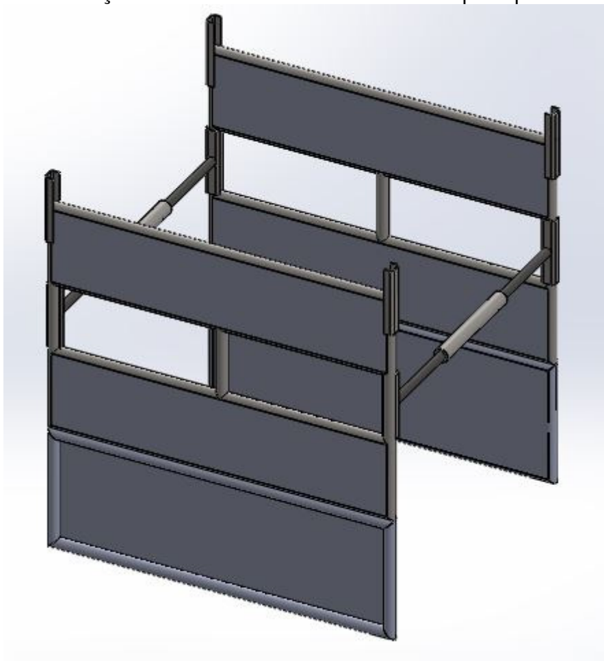
Adição da estrutura inferior na estrutura principal
