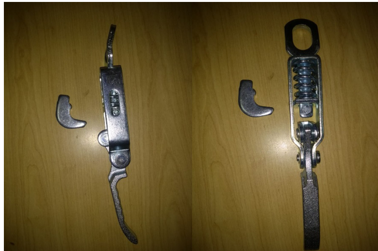
Figura 4: Trava ajustável usado na lateral da estrutura.
